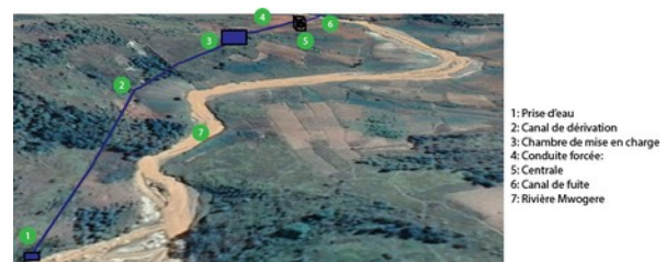
Fig. 8. Schéma d'une microcentrale hydroélectrique
